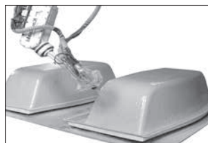
Зміцнення форми Посилення форми за допомогою смоли та скловолокна.
