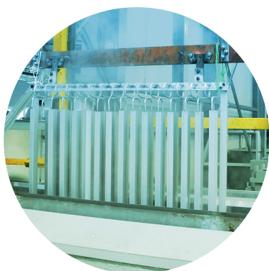
Гальванічний цех RAVAK Анодування алюмінієвих профілів - виготовлення самих міцних душових кабін, дверей і штор для ванн.
